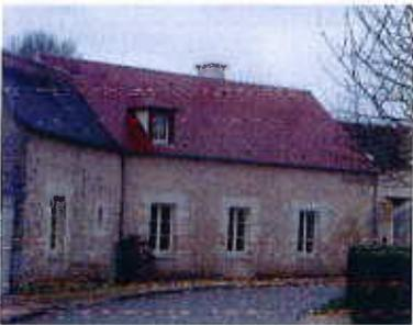
La construction forme un parallélépipède rectangle étroit et de plain-pied, surmonté d'un toit à deux pentes à 45°, encadré généralement par des souches de cheminées établies dans le prolongement des pignons. Sa hauteur au faitage est comprise entre 6 et 9 mètres depuis le sol. Sa longueur varie de 13 à 18 mètres et sa largeur de 5 à 7 mètres. Des annexes sont accolées à ce volume principal.
