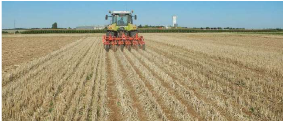
Figure 15: travail du sol limité (strip-till)
